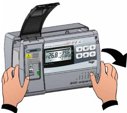
Fig. 3: Aprire il frontale della scatola sollevandolo e facendo scorrere le due cerniere fino a fine corsa. Flettere le cerniere e ruotare il frontale di 180° verso il basso per accedere all'interno del quadro
