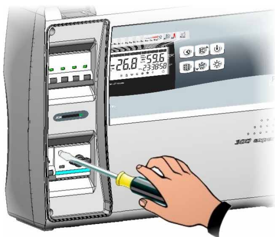
Fig. 14: Effettuare la taratura del salvamotore in base all'assorbimento rilevato. In ogni caso il valore impostato non deve essere superiore a quello massimo previsto dal costruttore del compressore. Attenzione: un errata taratura può causare il guasto del compressore o interventi indesiderati del salvamotore.
