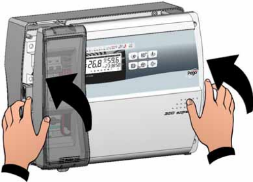
Fig. 15: Richiudere il coperchio frontale, ponendo attenzione che tutti i cavi siano all'interno della scatola e che la guarnizione della scatola sia correttamente alloggiata nella propria sede.
