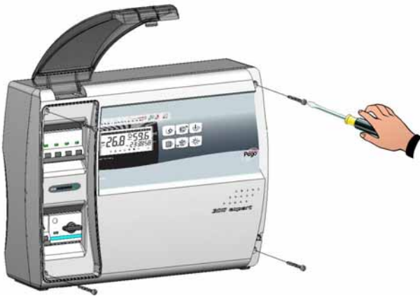
Fig. 16: Serrare il coperchio frontale con le 4 viti, riutilizzando gli O-ring presenti sulla gola di ciascuna vite. Riposizionare la copertura delle viti sul lato destro.
